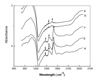
Figure 5 FTIR spectra of  $Fe_3O_4$ @Au (a),  $Fe_3O_4$ -LAA (b) huPrPrec (c),  $Fe_3O_4$ @Au-huPrPrec (d)  $Fe_3O_4$ -LAA-huPrPrec(e).
